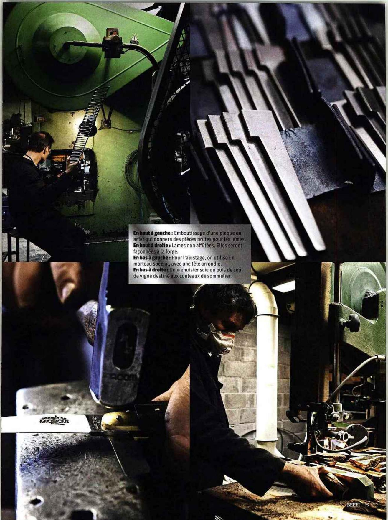
**En haut à gauche :** Emboutissage d'une plaque en acier qui donnera des pièces brutes pour les lames.
